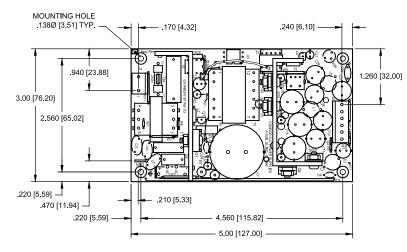
MAX. COMPONENT HEIGHT 1.25 [31.75] MAX. LEAD PROTRUSION 0.10 [2.54]
